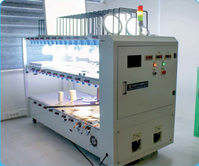
Yaşlandırma testi ile armatürlerin ömür analizi
