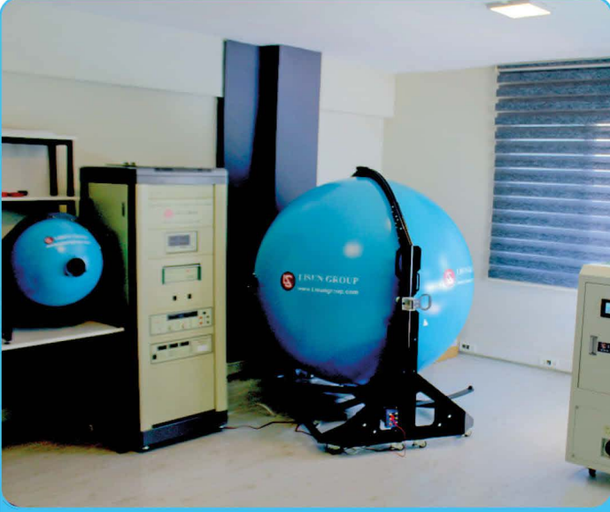
Spektrodyometre ve Entegre Küre Sistemi ile ürünlerin fotometrik analizi
