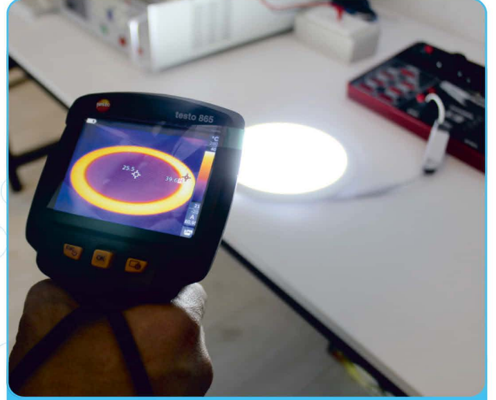
Ürünlerin çalışma sıcaklıklarının tespiti, panelin soğutma işlevi kontrolleri
