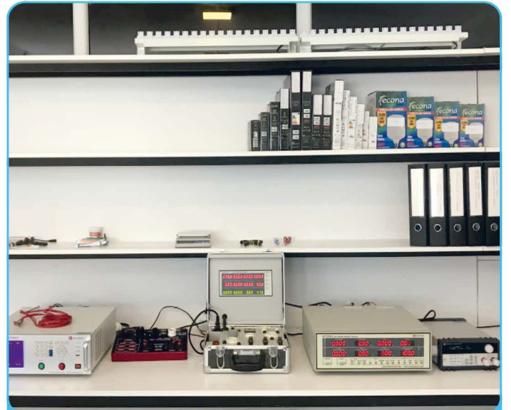
Yüksek voltaj, topraklama sürekliliği, yalıtım direnci testleri ve sürücü kartlarının (driver) elektriksel analizleri
